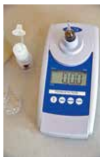
Dieses Messgerät dient zur Bestimmung der Restmenge von Peressigsäure im Abwasser.
