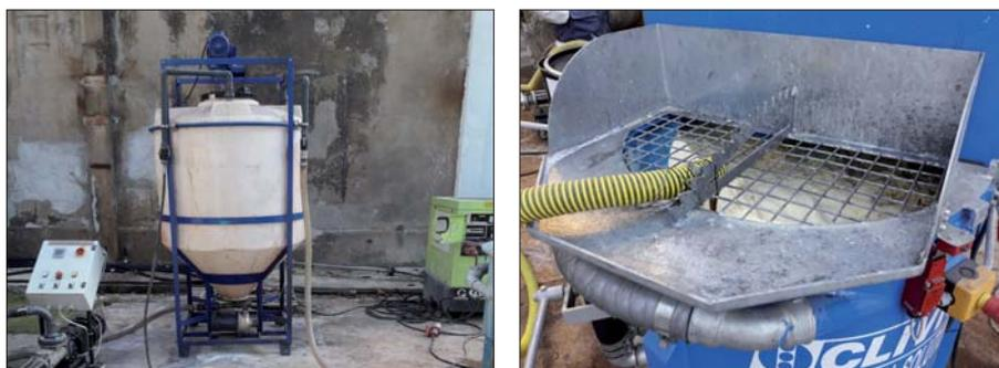
Figura 7. Vasca di pre-miscelazione (a sinistra) e vasca di miscelazione finale con sistema di ricircolo in linea (a destra)
