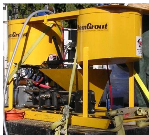
Figura 1 – Unità di miscelazione ChemGrout CG-500, con pompa a pistone ad alta pressione
